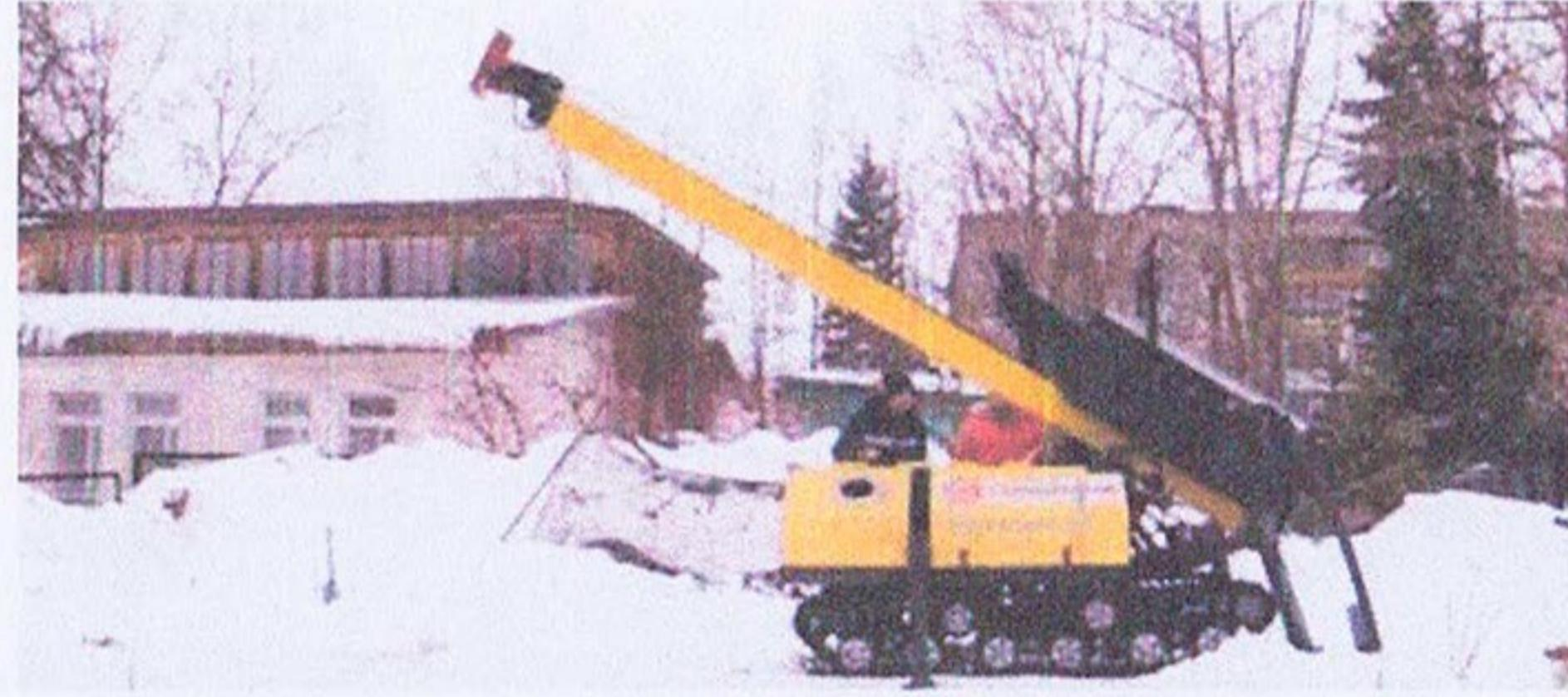
Установка приводится из транспортного в рабочее положение: опускаются и фиксируются на земле гидравлические опоры, поднимается стрела. С помощью установленной на стреле лебедке свая поднимается наверх.
